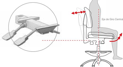
El mecanismo Sincro realiza un movimiento basculante sincronizado del asiento y del respaldo sobre el eje central de la silla.
