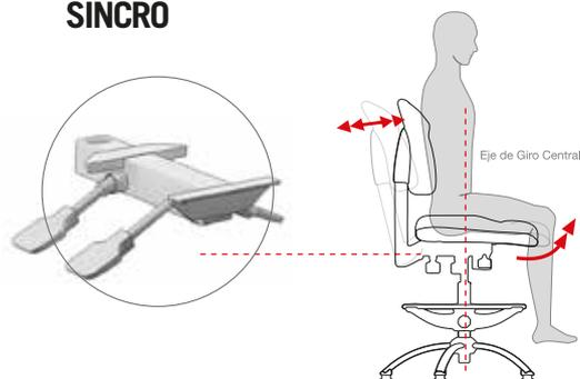
El mecanismo Sincro realiza un movimiento basculante sincronizado del asiento y del respaldo sobre el eje central de la silla.
