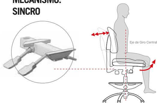
El mecanismo Sincro realiza un movimiento basculante sincronizado del asiento y del respaldo sobre el eje central de la silla.
