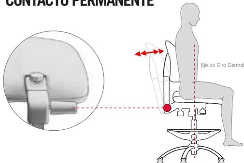
El mecanismo de Contacto Permanente permite ajustar el grado de inclinación del respaldo y fijarlo en diferentes posiciones.
